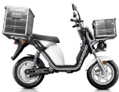
**e-MO XP** est doté d'un moteur de 2kW (2,7ch) - soit le double de son cadet e-MO, lui conférant des accélérations franches et une vitesse constante sélectionnable à 30km/h ou 45 km/h, quels que soient la charge et le profil de la route afin de satisfaire aux contraintes des professionnels de la livraison ou de la messagerie en ville.
